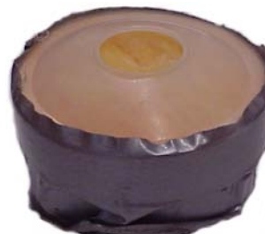
Combinación inapropiada de cartucho y filtro. (Partes de diferentes marcas sujetas con cinta adhesiva.)
